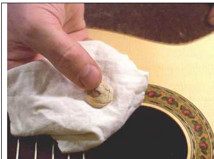
Jádro munece vyrobené z 18palcové bavlněné gázy.
